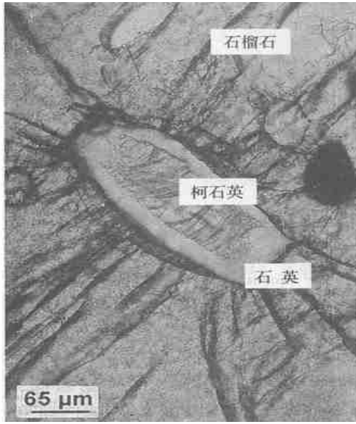
图 1 大别山石榴石-柯石英包裹体在透射电子显微镜下的图像及其模拟示意图
