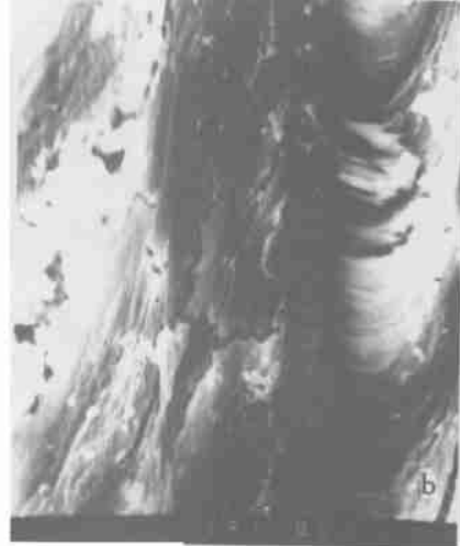
照片3 \beta 半水石膏的扫描电镜图象 a. 原矿物的(100)面; b. 原矿物的(010)面
